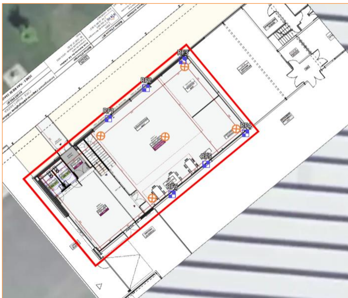
Plan d'implantation des sondages de reconnaissance des fondations
